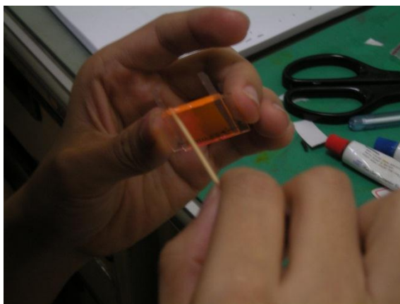
將液晶片兩側封上 AB 膠(圖三)
